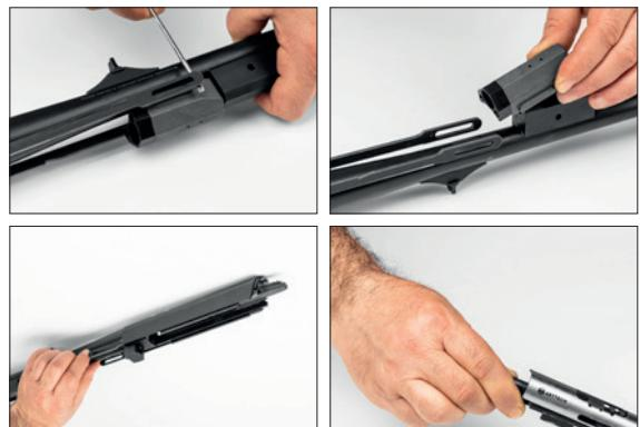
6. Üst gövdeyle namluyu ayırmak için 12'lük anahtar kullanarak namlı bağlantı civatasını saat yönünün tersi yönde çevirerek sökün ve namluya üst gövdeyi birbirinden ayıran.
