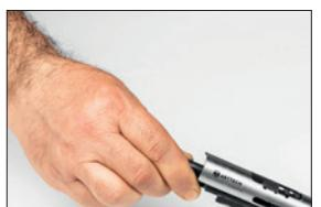
5. Чтобы снять ствол с верхней части ствольной коробки, ключом на 12мм открутите винт крепления ствола и разъедините их.
