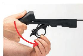
7. Dipçiği tüfekten ayırmak için önce omuzluk pedini altında bulunan pime basarak çıkartın. Daha sonra 5'lik alyan yardım ile içerisinde bulunan cıvatayı saat yönünün tersi yönde çevirerek sükün ve dipçiği gövdeden ayırin.
