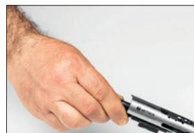
5. Üst gövdeyle namluyu ayırmak için 12'lik anahtar kullanarak namlu bağlantı civatasını saat yönünün tersi yönde çevirerek söküp ve namluya üst gövdeyi birbirinden ayırmak.
