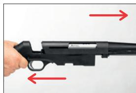
4. Чтобы снять кожух затвора, отделите раму от тяги с помощью отвертки с прямым шлицем. После этого возьмитесь за кожух и потяните его до упора назад.
